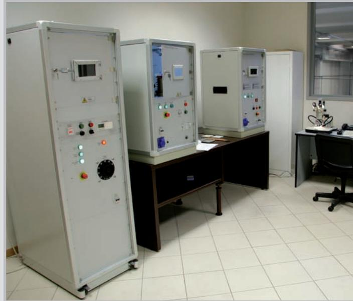
**Laboratorio Prove Elettroniche per test di resistenza all'arco voltaico. Isolamento nel senso dello spessore e tra spinn-rigidità elettrica fino a 30KV.**
