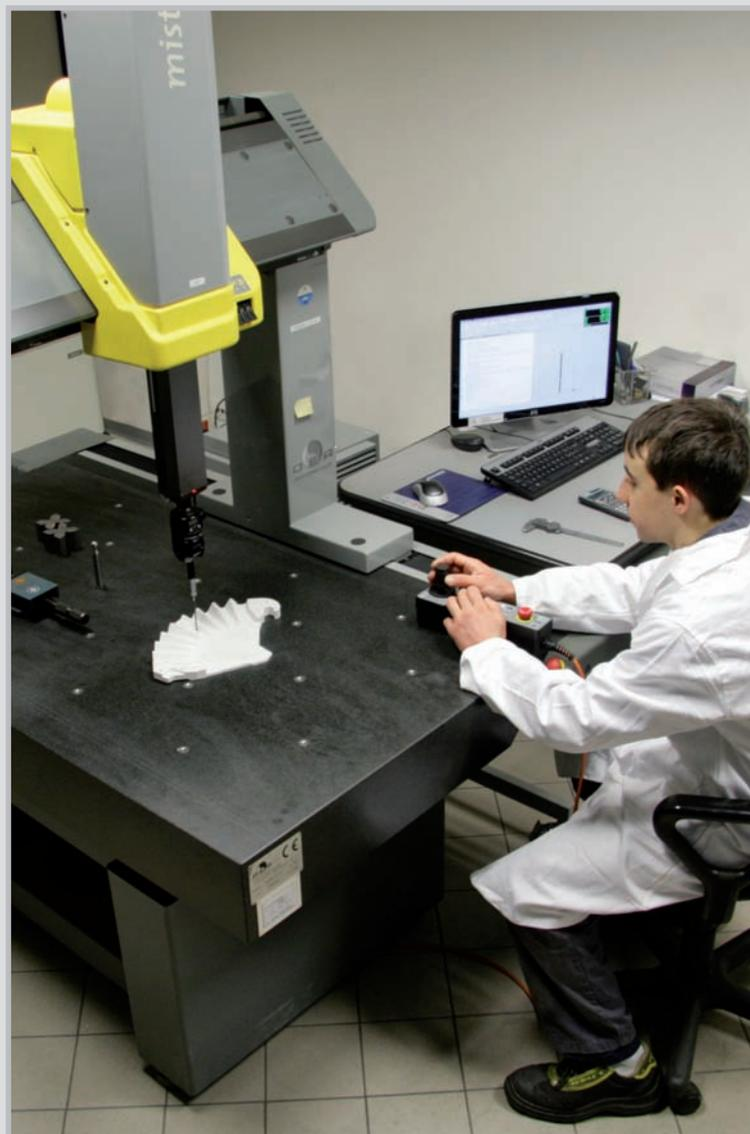
**Macchina di misura 3D (per verifiche dimensionali e scansioni in continuo per rilevamento della matematica) per manufatti complessi.**
